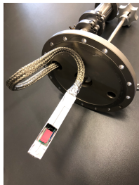
Obr.: Detektor na manipulátoru
