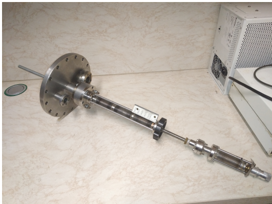
Obrázek: Nový manipulátor.
