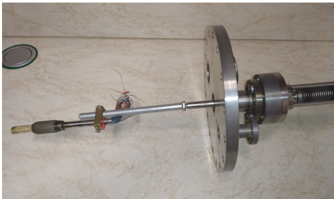
Obrázek: Hlavice sondy umístěná na novém manipulátoru s prodloužením.
