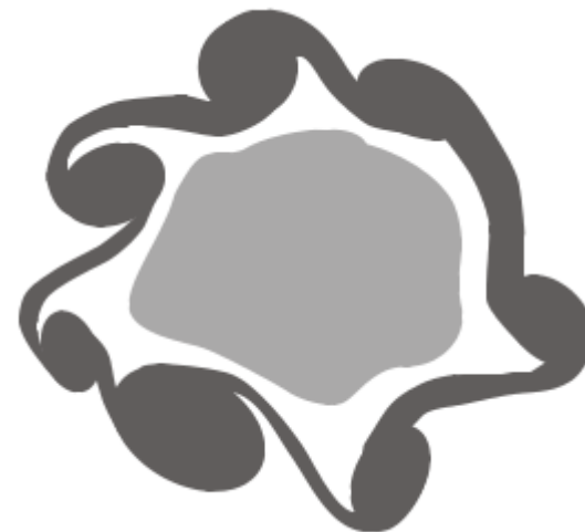
Obr. 3: Priečný rez plazmového vlákna s diocotronovou nestabilitou. [3]
