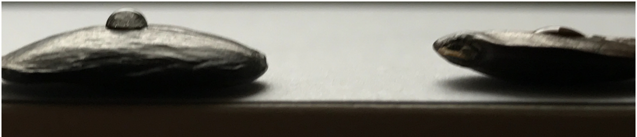
Obr. 1 – Znázornění změny povrchové energie semene vístárie po ošetření nízkoteplotním plazmatem pomocí tvaru kapky vody na jejím povrchu.
