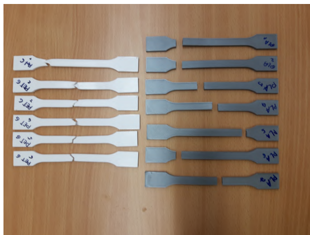
Obrázek 2: 13 zkušebních těles, 7 PLA, 6 PETG po tahové zkoušce
