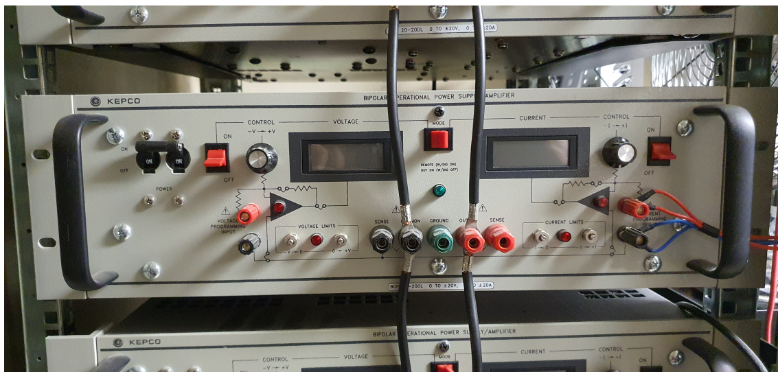
Obrázek 1.5: Ukázka proudového zesilovače KEPCO konfigurace 20V/20A. Tento zesilovač společně s dalšími mezi sebou propojenými slouží pro magnetickou stabilizaci +polohy plazmatu+ na tokamaku GOLEM.
