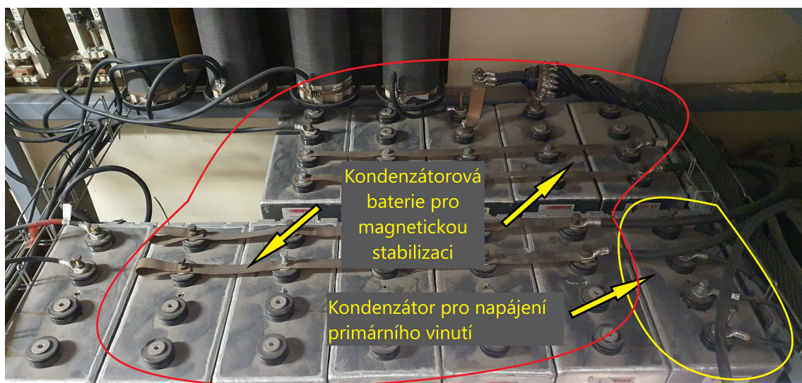
Obrázek 1.2: Ukázka/ *Foto* transformátorové baterie tokamaku GOLEM. Převzato z [kondenzator_prozatimni].
