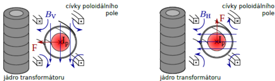
Obrázek 1.5: Schéma tekoucího proudu poloidálními cívkami pro vychýlení plazmatu příslušným směrem. Převzato z [Jindra_DP].
