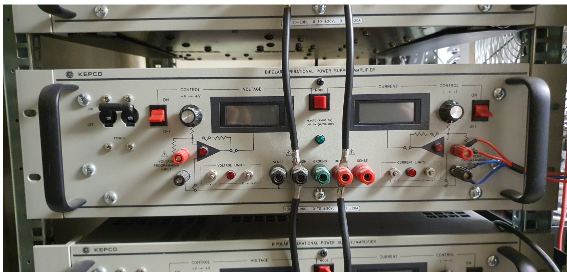
Obrázek 4.5: Ukázka proudového zesilovače KEPCO konfigurace 20V/20A. Tento zesilovač společně s dalšími mezi sebou propojenými slouží pro magnetickou stabilizaci na tokamaku GOLEM.
