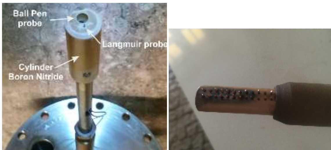
Obrázek 2.8: Kombinovaná sondová hlavice osazená Langmuirovou a ball-pen sondou (vlevo) a pole Langmuirových sond (vpravo) na tokamaku GOLEM.
