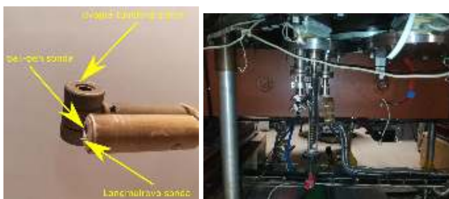
Obrázek 4.1: Schéma tunelové sondy v komoře tokamaku GOLEM nahoře, fotografie kombinované sondové hlavice vlevo, fotografie manipulátoru vloženého do spodního diagnostického portu tokamaku GOLEM vpravo.
