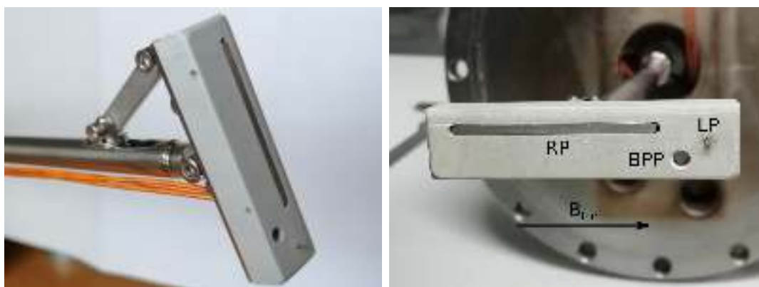
Obr. 2.4: Hlavice rail sondy před instalací na tokamak GOLEM (fotografie nalevo). Odinstalovaná hlavice z tokamaku GOLEM po zhruba 350 výbojích (fotografie napravo).
