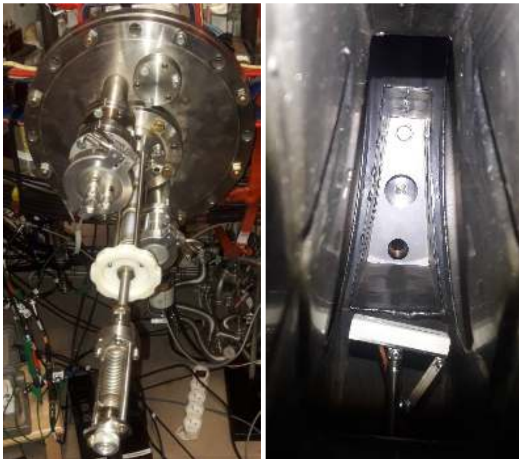
Obr. 2.2: Manipulátor rail sondy instalovaný na LFS tokamaku GOLEM (fotografie nalevo). Hlavice rail sondy uvnitř komory při pohledu z horního portu (fotografie napravo).
