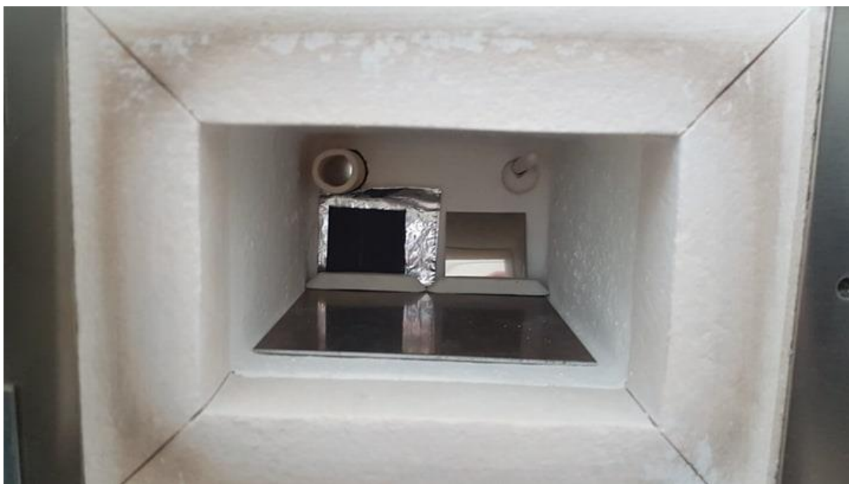
Obr. 12: Umístění grafitové kalibrační destičky (vlevo) a tantalové destičky (vpravo) v peci.
