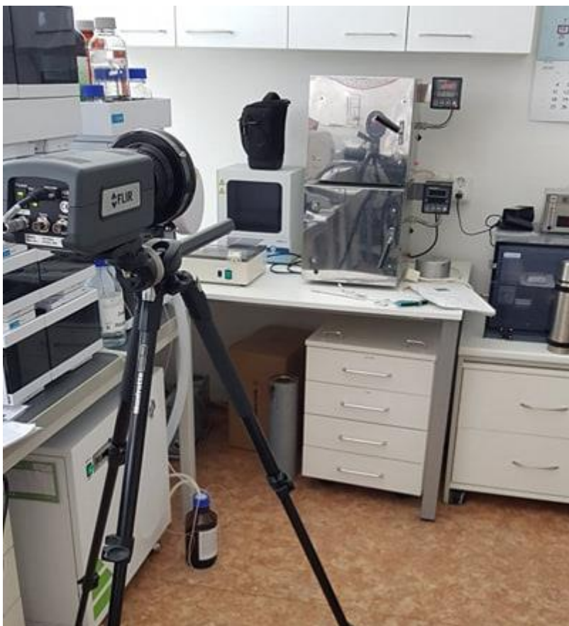
Obr. 11: Termokamera umístěná ve stojanu mířící na laboratorní pec.
