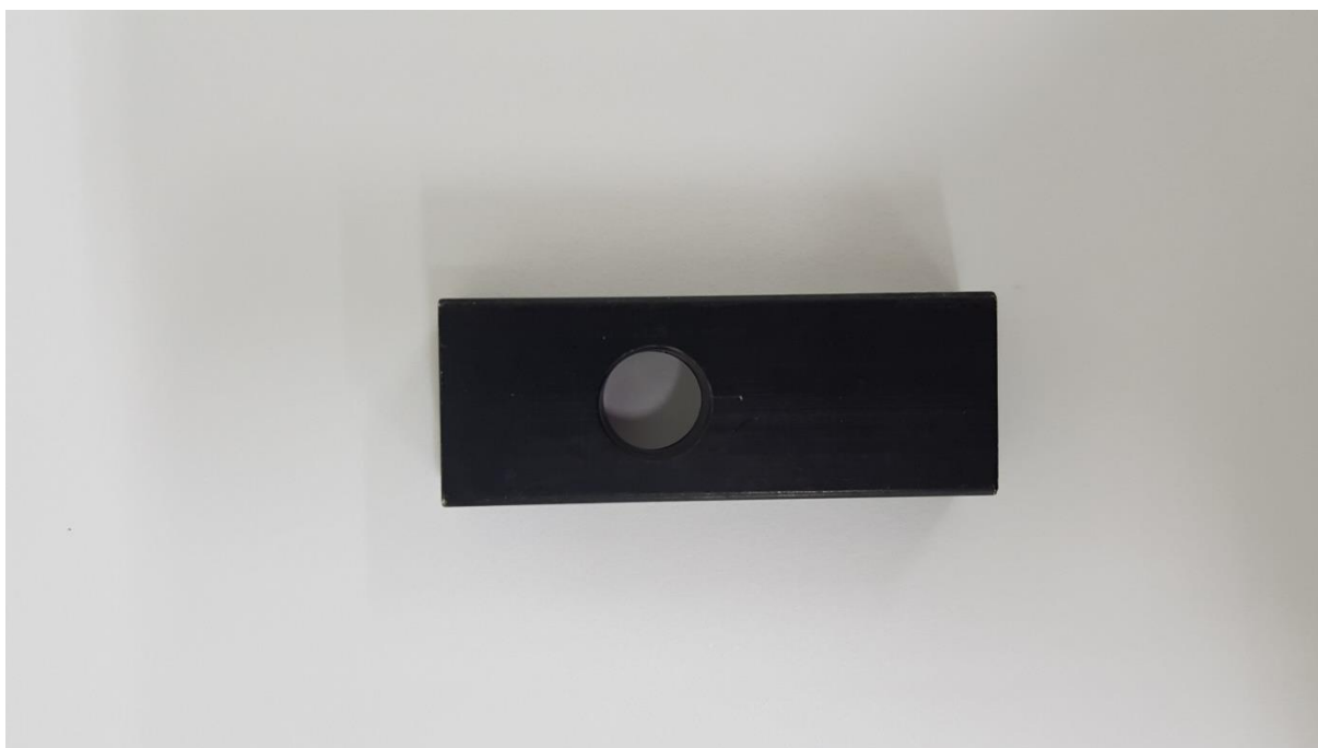
Obr. 13: Referenční předmět pro měření příčného zvětšení termokamery s využitím mezikroužků.
