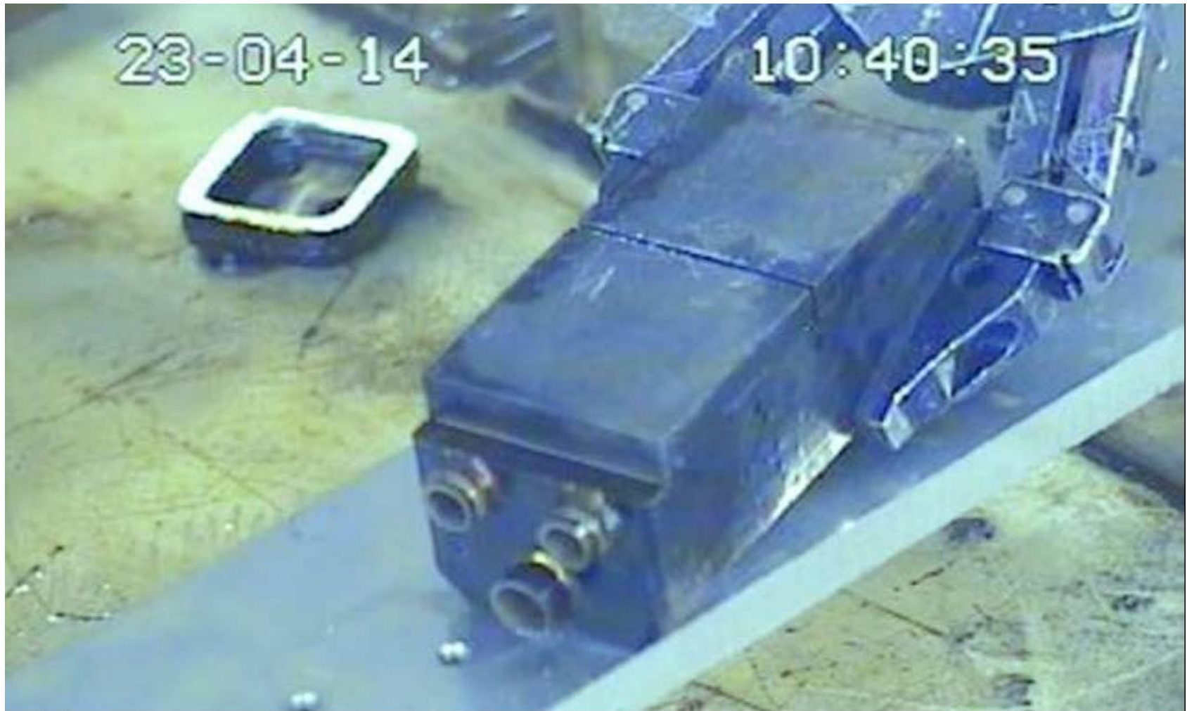
Vzorek první stěny reaktoru ITER v horké komoře po vyjmutí z jaderného reaktoru. CV Řež
